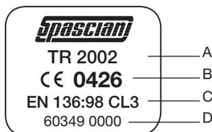
A. Die Typbezeichnung TR 2002, S weist darauf hin, dass die Maske aus Silikon gepresst.
