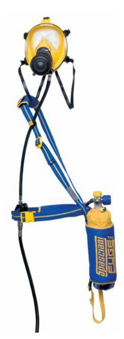
**FUGE TAIL** è un autorespiratore ad aria compressa per la fuga (Emergency Escape Breathing Device) che in caso di emergenza fornisce un flusso di aria respirabile, a domanda, per un tempo minimo garantito di **15 minuti**. E' destinato all'uso in tutti gli ambienti in cui si possono verificare situazioni pericolose dovute alla presenza di fumi di incendio o mancanza di ossigeno.
